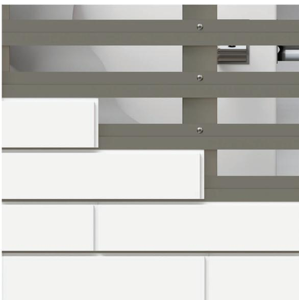
Облицовочный камень возможно закрепить на любые подсистемы, представленные на рынке вентилируемых фасадов. Затирка швов для данного крепления осуществляется на дополнительно установленные в пропил перфорированные ленты.
